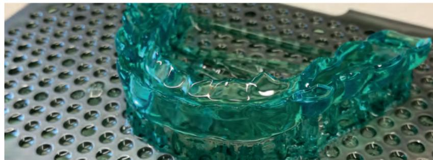
Prototyp einer Aufbiss-Schiene aus dem 3D-Drucker
